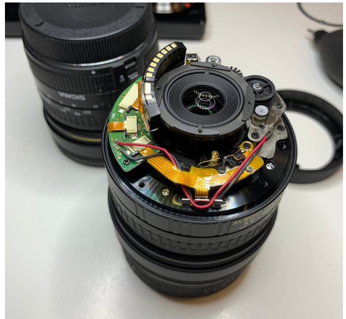
De FOS shutter wordt in de fish-eye lens ingebouwd.
