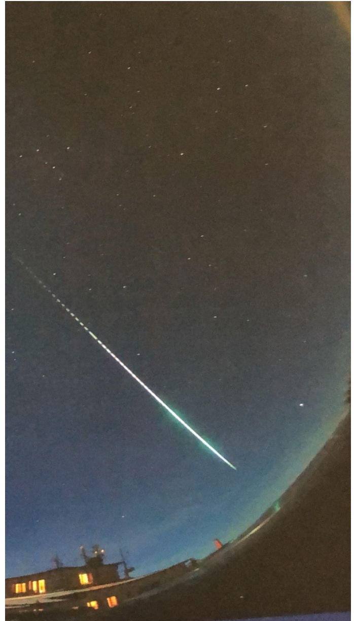
Fish-eye opname van een vuurbol, vastgelegd met een ingebouwde FOS LCD shutter, GPS gesynchroniseerd. De breaks op de hele seconde zijn vervallen. (Foto Tsjechische Academie van Wetenschappen)
