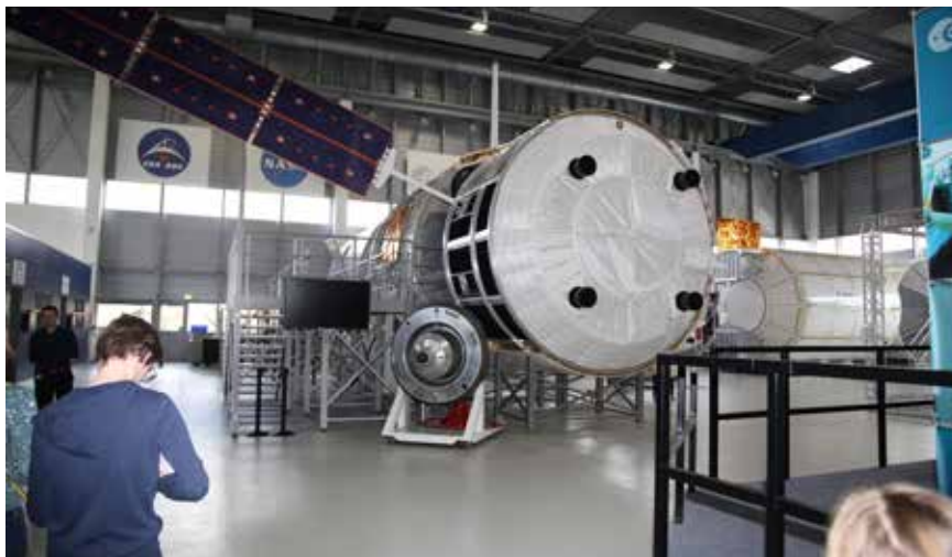
Boven. Op de voorgrond de ATV; dit is een Europese bijdrage die instaat voor de bevoorrading van het ISS, het aanbrengen van experimenten en de afvoer van afval (door verbranding in de atmosfeer).
