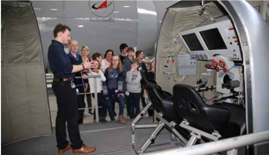
Maxim Mommerency geeft uitleg bij de in twee gezaagde module. In de cabine is plaats voor drie personen, de plaats in de cabine moet ook worden gedeeld met cargo zodat de vrije ruimte extreem beperkt is. De commandant moet met een stokje de knoppen bedienen die buiten handbereik liggen.
