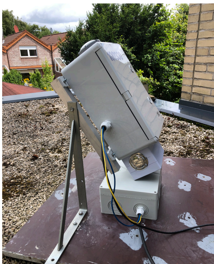
Figuur 7. Een aangepaste versie voor de behuizing van de CAMS2.0 opstelling van Carl Johannink in Gronau.
