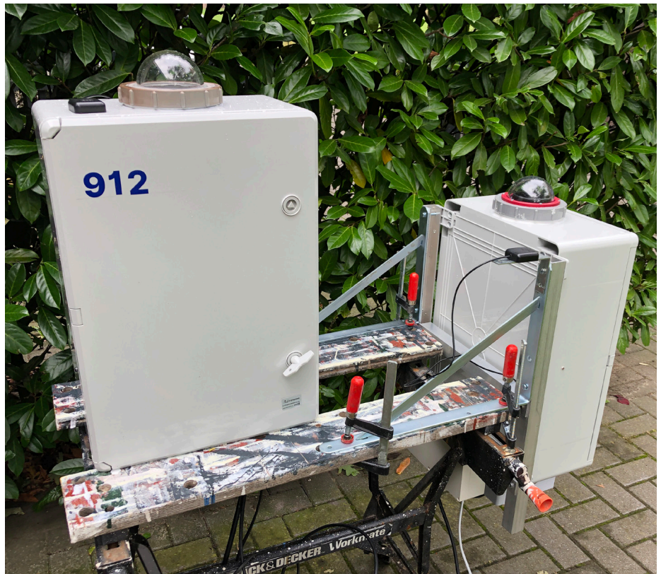
Figuur 3. De opstellingen voor EN912 Bruchhausen-Vilsen en EN917 Göttingen in de testopstelling. Gedurende enkele weken is de continuïteit van de opnamen gecontroleerd en is de temperatuurregeling ingesteld.
