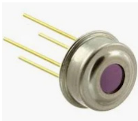
Figuur 3. De nabij-infraroodsensor MLX90614 van Melexis in een TO-39 omhulling.
