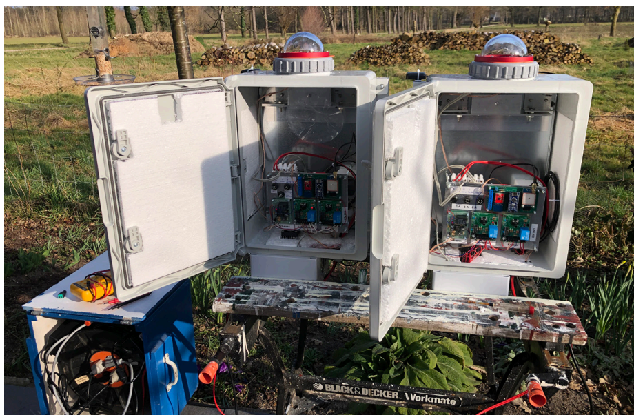
Figuur 2. Testen, testen, testen... Alvorens een opstelling ergens te installeren wordt er uitgebreid getest. Koeling voldoende? Koepel blijft dauwvrij? Geen vocht in de kast? Opnamenreeks loopt goed? Hier de camera's voor Humain en Engelmanshoven op de proefbank.
