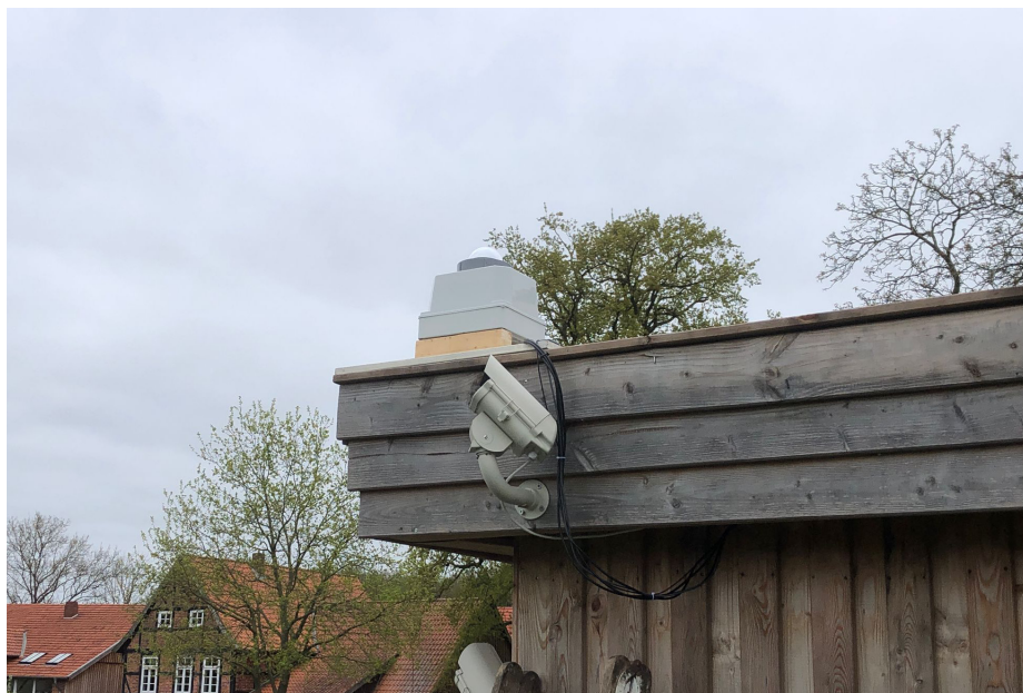
Figuur 17. All sky post EN912 te Bruchhausen-Vilsen, in bedrijf sinds half april 2025 in zijn tijdelijke opstelling op de rand van de koepel van de sterrenwacht. Omdat de koepel een stukje obstructie geeft wordt de opstelling later dit jaar naar een definitieve locatie verplaatst en wordt de camera door een Canon-R vervangen.
