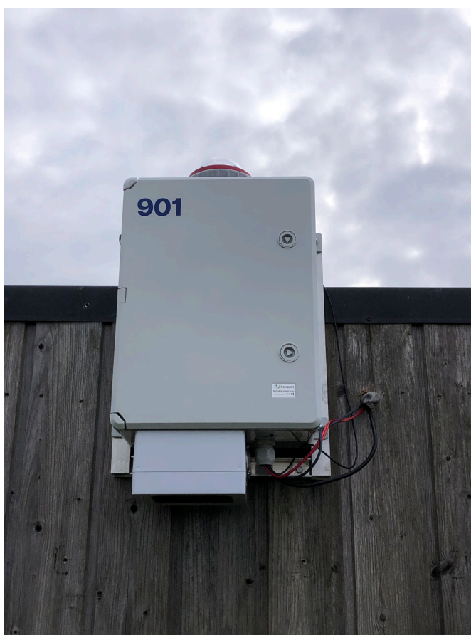
Figuur 10. Op zaterdag 15 maart 2025 werd de opstelling in Humain vervangen door een all-sky NG opstelling. Het peltier element met de koelventilatoren hangt onder de kast.
