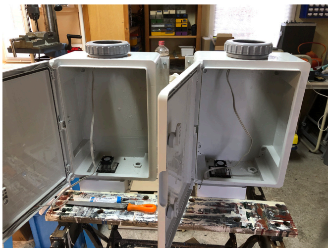
Figuur 14. In de verder nog lege behuizingen zijn de peltierelementen met koelventilatoren aan de onderkant zichtbaar.
