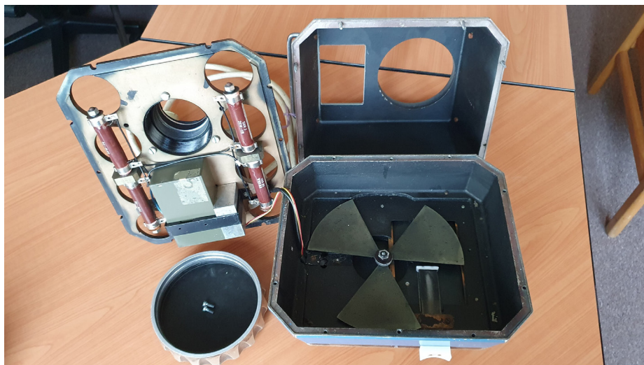
Figuur 6. Interieur van een Tsjechische EN-opstelling uit de jaren 80 en 90 van de vorige eeuw. De Zeiss Distagon lens is verwijderd. De driebladige sector draaide binnen de camera's vlak voor de platenhouder. Foto: Pavel Spurný.
