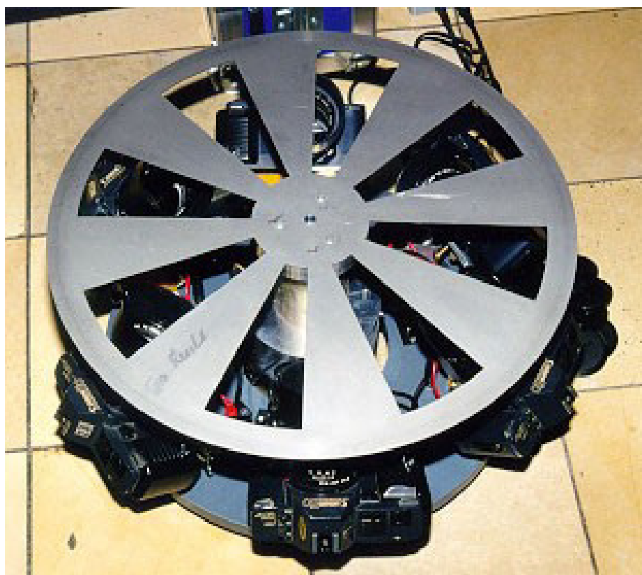
Figuur 5. Met deze motor en een achtbladige sector konden 100 afdekkingen per seconde worden bereikt. Deze unit werd ondermeer gebruikt in de zgn. hazenbatterijen die belangrijke data leverden tijdens de Sino-Dutch Leonid expeditions in 1998 en 2001. Foto: Robert Haas
