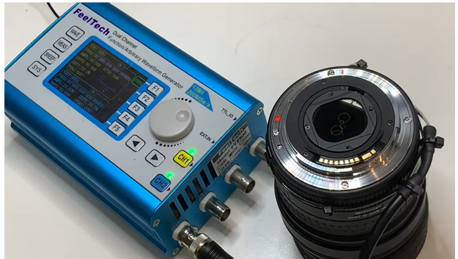
Figuur 10. Een FOS shutter ingebouwd in een Sigma f/3.5-8 mm lens met een kleine functiegenerator die het 16 Hz signaal opwekt. Van deze laatste wordt nu geleidelijk aan afscheid genomen. Foto: Marco Verstraaten.
