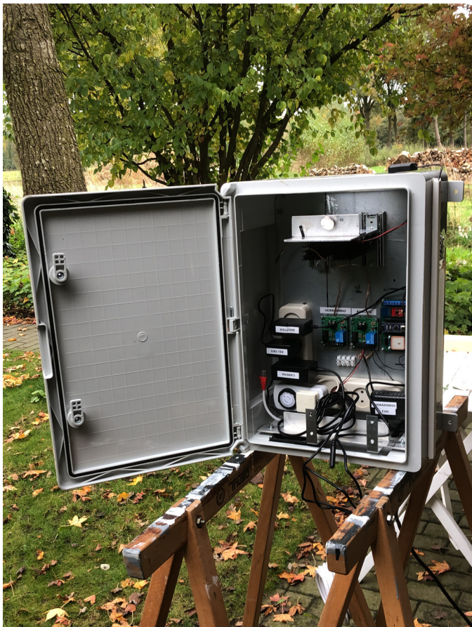
Figuur 2. De behuizing als testopstelling. Alle netaansluitingen, tijdklok voor de LCD shutter en electronica. De camera en de computer zijn niet geplaatst.
