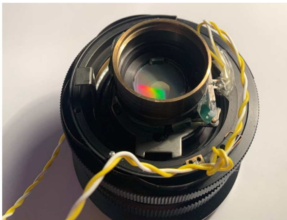
Figuur 3. Prototype met dubbel tralie en LC shutter samengebouwd binnen in de Distagon 16mm lens. De laatste lensgroep, bovenop, ontbreekt nog.
