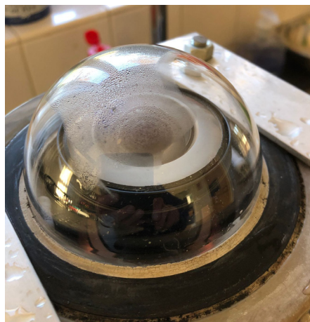
Figuur 2. Condensatie aan de binnenkant van een venster betekent dat er onvoldoende verwarmd wordt.
