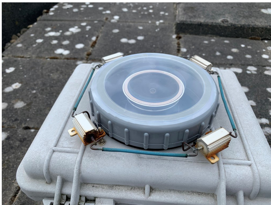
Figuur 1. Tralie folie in plaats van het horlogeglas gemonteerd op een PVC ring voor de fisheye lens van EN920 in Dwingeloo.
