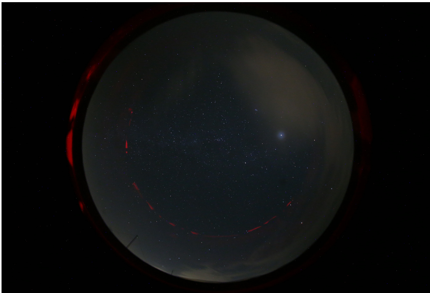
Figuur 6. Droomlocatie Humain. Zicht van horizon tot horizon en nauwelijks strooilicht. Deze opname vn 31 oktober, de dag na de installatie is één van de weinige heldere uit de voorbije periode. Het rode strooilicht van de LEDs is inmiddels verholpen. Na enkele heldere minuten trok al weer bewolking het cameraveld binnen. Voldoende om de lens te calibreren en de kwaliteit van het afdekglas te beoordelen.
