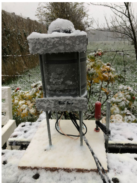
Figuur 3. De winter viel in 2024 medio november en duurde één dag. Een perfecte gelegenheid om het nieuwe verwarmingssysteem op de opstelling te testen. Binnen een uur was de sneeuw op het koepeltje verdwenen en was het zicht helder.
