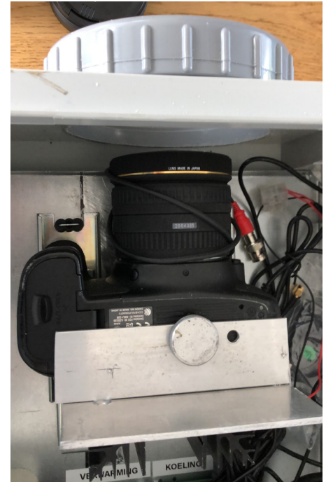
Figuur 1. Camera en objectief worden met behulp van een slede omlaag getrokken zodat de camera gemakkelijk uitgenomen kan worden. Links: in de bedrijfsstand, objectief in de lenskoker; rechts omlaag geschoven, camera kan worden uitgenomen.
