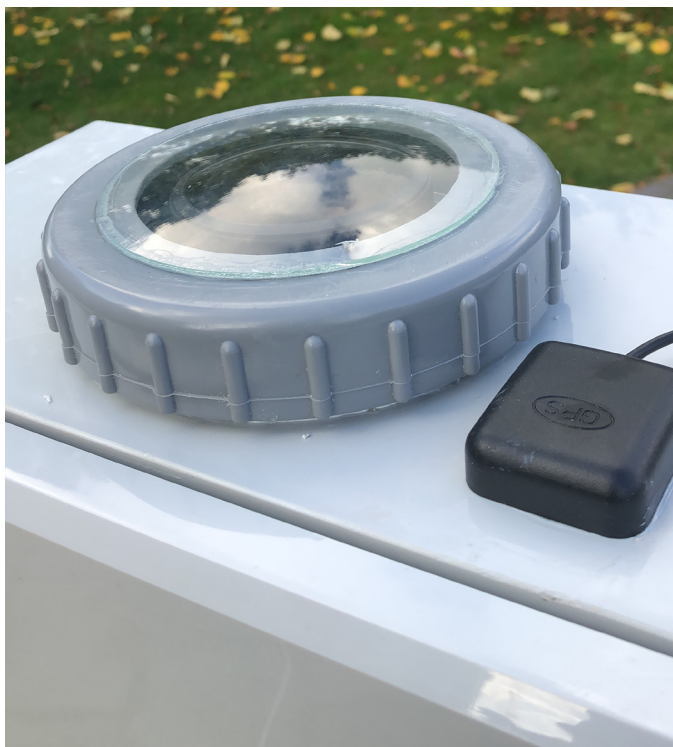
Figuur 4. Het afdekvenster (klokkenglas) en de antenne van de GPS gestuurde LCD shutter bevinden zich boven op de kast.
