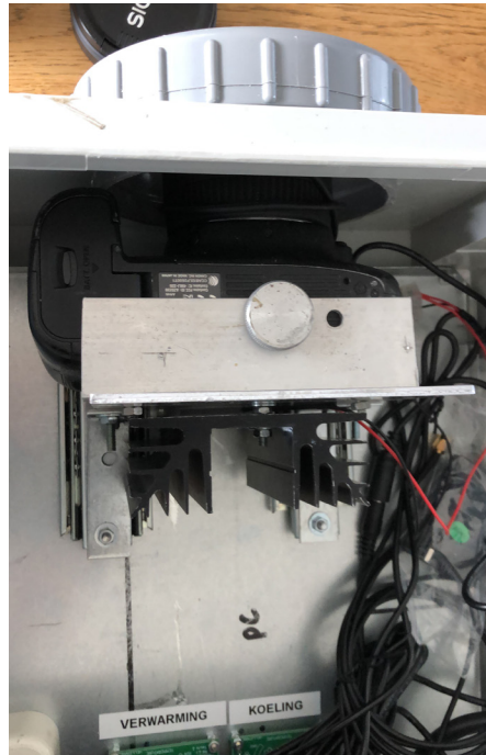
Figuur 1. Camera en objectief worden met behulp van een slede omlaag getrokken zodat de camera gemakkelijk uitgenomen kan worden. Links: in de bedrijfsstand, objectief in de lenskoker; rechts omlaag geschoven, camera kan worden uitgenomen.
