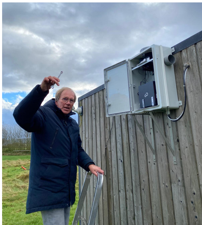
Figuur 5. All Sky toestel EN901 geplaatst in Humain op 30 oktober 2024. De (mini) PC bevindt zich aan de voorkant.
