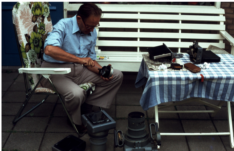
Figuur 3. Revisie van een F-24 betekende volledige demontage en de nodige onderdelen vervangen. Wijlen mijn vader hield zich na zijn pensioen graag met dit soort klussen bezig. (1979)
