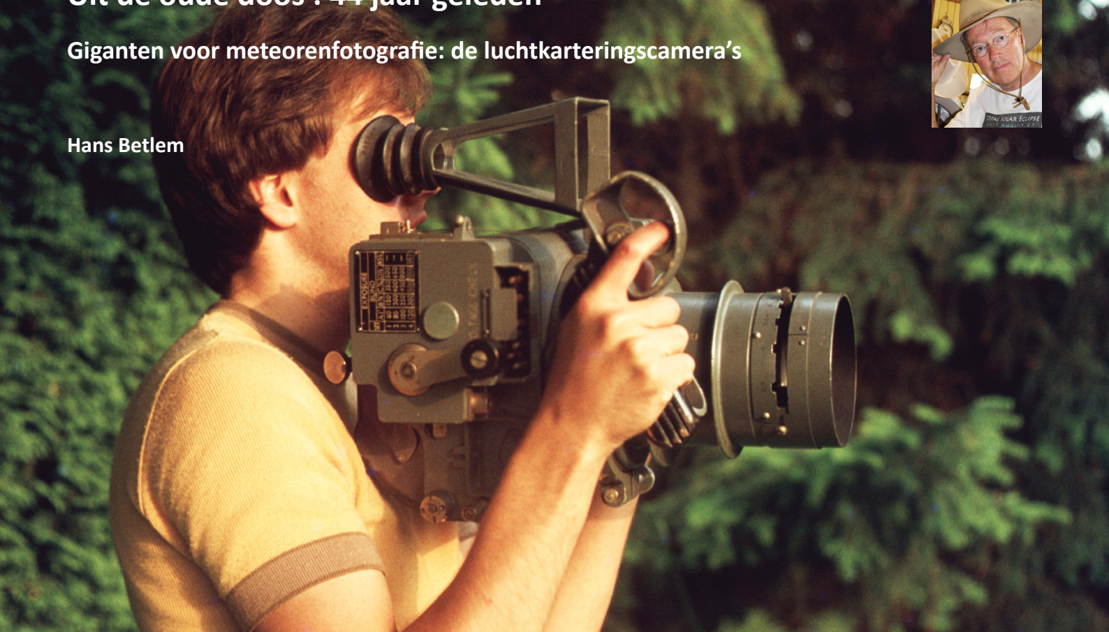
Figuur 1. De F-24 luchtkarteringscamera zoals we hem kochten inclusief onnodige zaken als vizier en draagbeugels. (1979)
