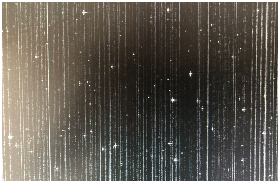
Figuur 5. Valse sterren en verticale strepen? Dan is de temperatuur van de camera véél te hoog!
