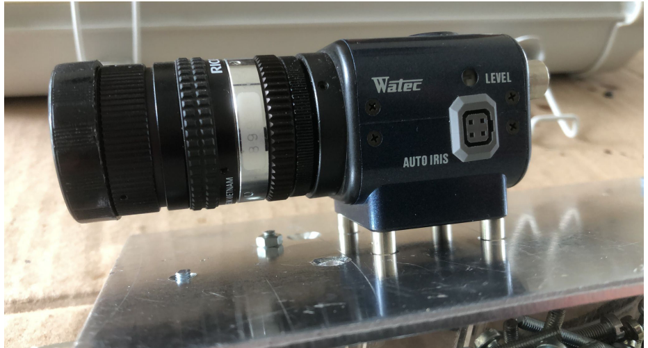
Figuur 3. De camera's bij voorkeur te monteren aan de vier aanwezige M3 schroefverbindingen. Alleen de 1/4" fotodraad gebruiken geeft geen stabiele verbinding.
