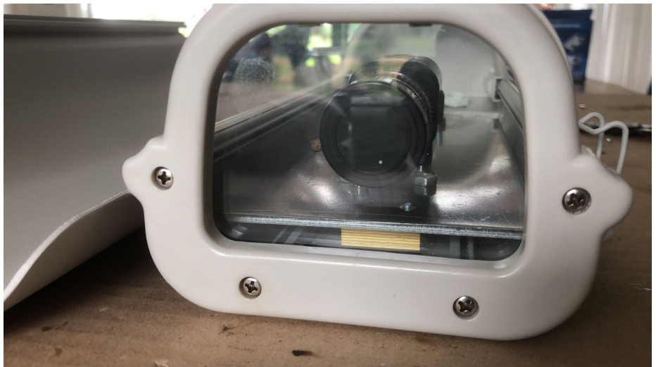
Figuur 4. Met stelbouten kan de camera mooi voor het venster gecentreerd worden. De verwarmingsweerstand is onder de camera te zien.
