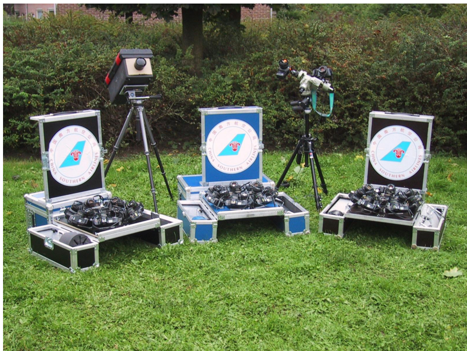
Figuur 2. Speciaal voor de Sino-Dutch Leonid expedition werd de zgn. Hazenbatterij ontwikkeld. Portable en als handbagage in het vliegtuig mee te nemen camerabatterijen met kristalgestuurde sector en 8 T-70 camera's. Foto: Robert Haas.
