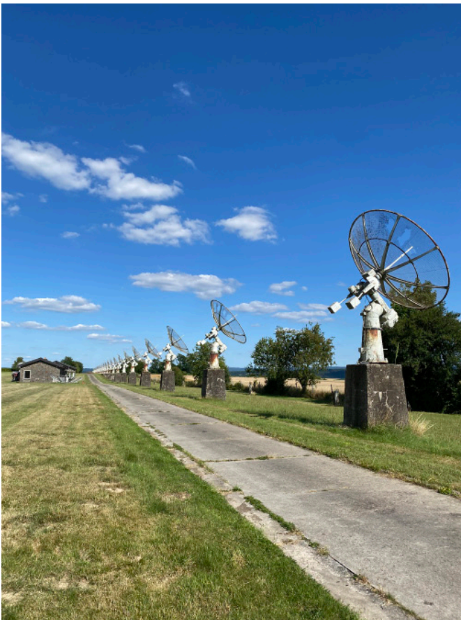
Figuur 2. Oude radiotelescopieën die gebruikt werden voor zonnewaarnemingen. Deze dienen vervangen te worden.
