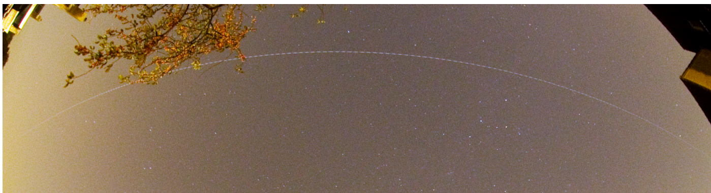
Figuur 3. Opname met EN900 vanuit Leiden. Canon 6D met Sigma f/3.5-8 mm. Shutter met 16 breaks per seconde.
