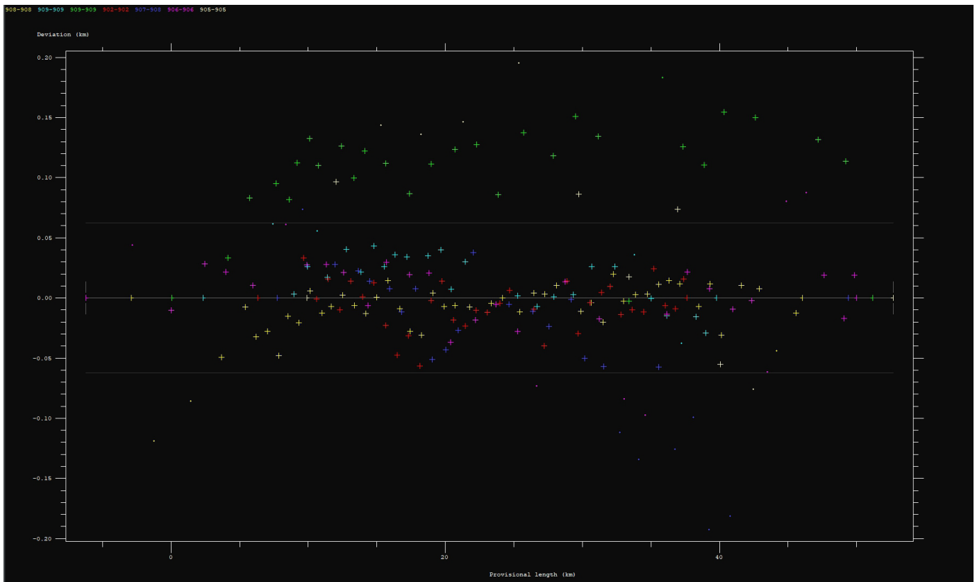
Figuur 8. Plot van de afwijking per meetpunt (in km; vertikaal) tegen de tijd (break nummer horizontaal). De verschillende optieken doen niet voor elkaar onder (weinig systematische afwijkingen). De meeste meetpunten liggen binnen de 100 meter van het gemiddelde. De gemiddelde nauwkeurigheid van alle meetpunten is 50 meter bij ongewogen toepassing van alle posten en 20 m bij gewogen toepassing van de posten..
