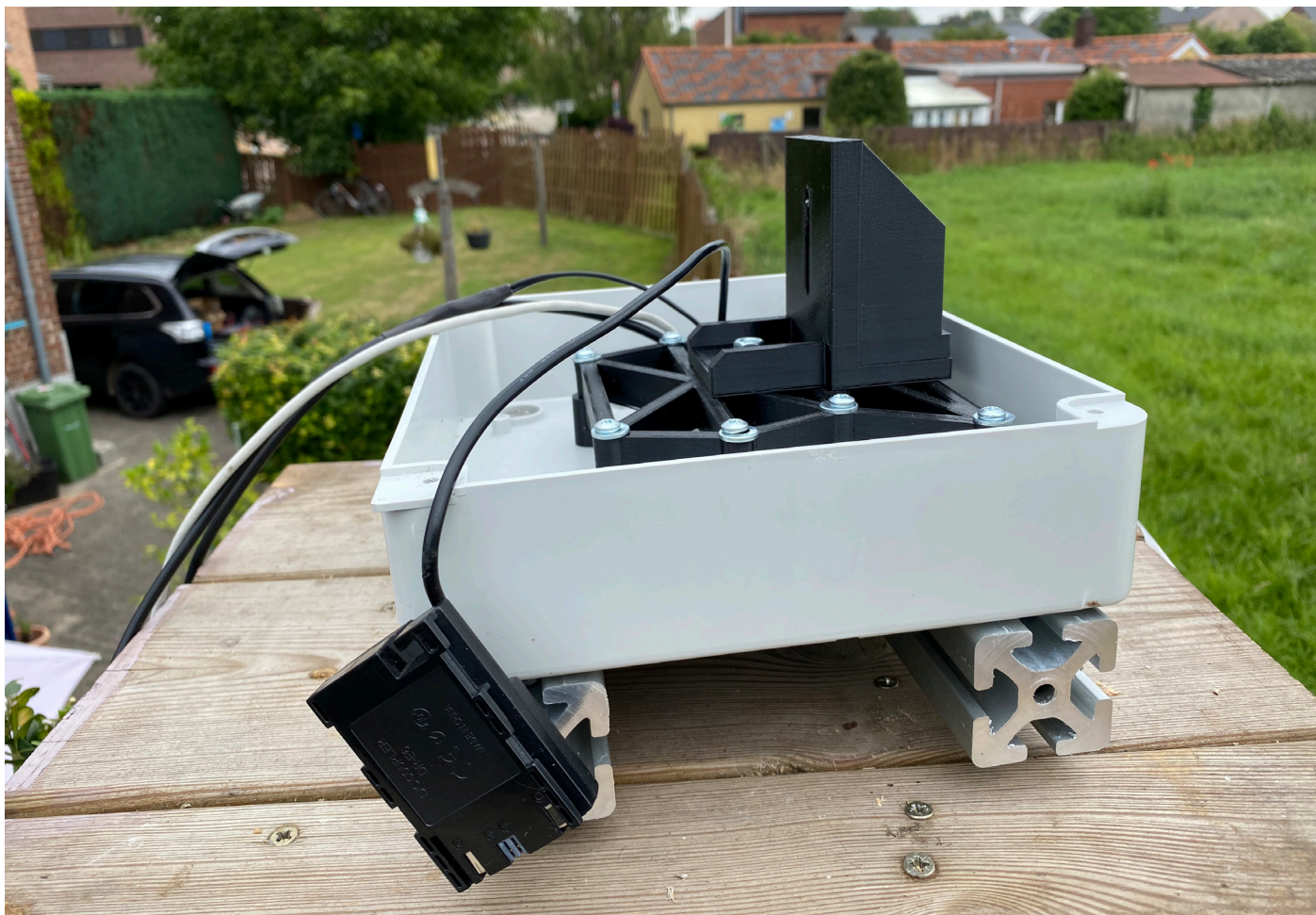
Figuur 3. Een kijkje in de behuizing van wat we inmiddels wel de 'standaard DMS all-sky opstelling' kunnen noemen. Identieke opstellingen zijn nu in gebruik in Wilderen, Leiden, Twisk, Benningbroek en tegen de tijd dat U dit leest Ermelo. Te zien zijn de 3D geprinte camerabevestiging en de dummy voeding voor de Canon 6D.
