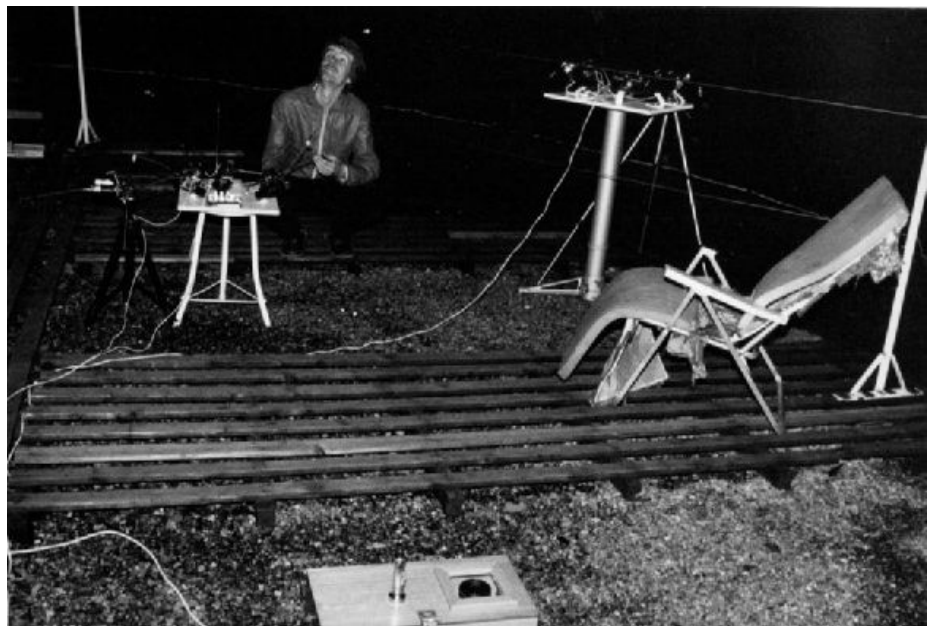
Figuur 2. Koen Miskotte bedient de camera batterijen. Op de voorgrond een eerste all sky camera bestaande uit een Canon AV1 met winder, voorzien van een Canon FD 17 mm F4.0 lens.
