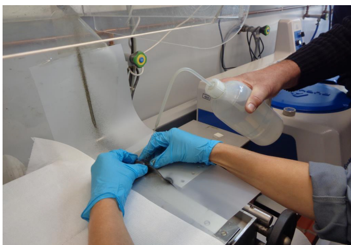
Figuur 15. De meteoriet wordt in twee stukken gezaagd en daarna onder vacuüm gedroogd.
