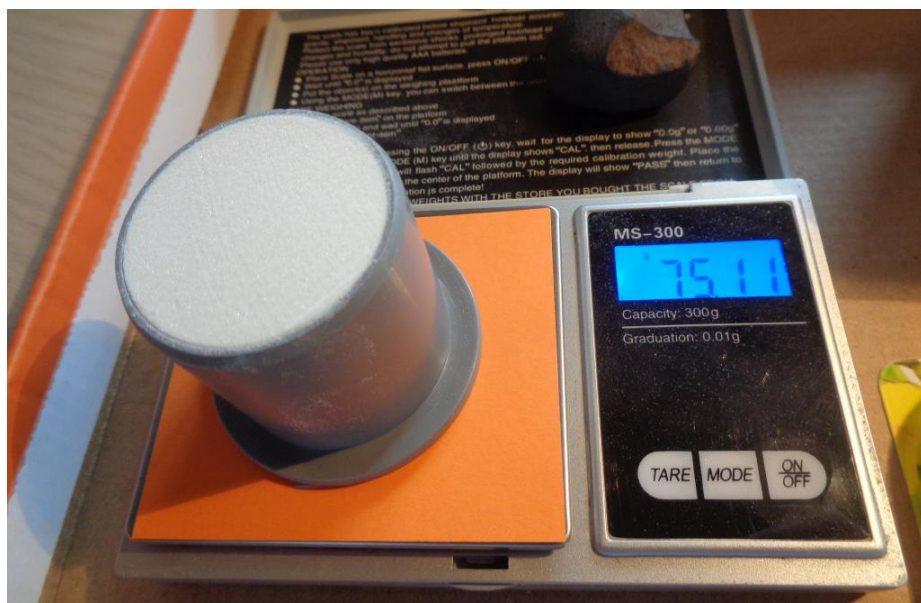
Figuur 9. Het volume van de meteoriet kon worden bepaald door onderdompeling in een reservoir met minuscule glaskogeltjes.
