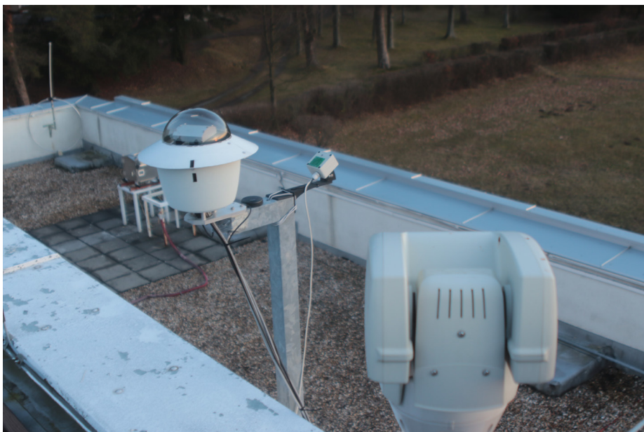
Figuur 12. (boven) Observatorium Kunžak: de high speed tracking camera met daarachter de PMT opstelling en wolkendetektor.
