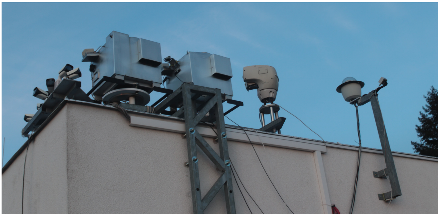
Figuur 6. (boven) Het complete meteorstation te Ondřejov met prominent twee DAFO opstellingen: één voor de directe fotografie en één voor de spektrografie. Rechts daarvan de high-speed tracking camera en de fotomultipliiër unit die deze camera aanstuurt. Links, verscholen achter de opstelling, de 16 Watec camera's.
