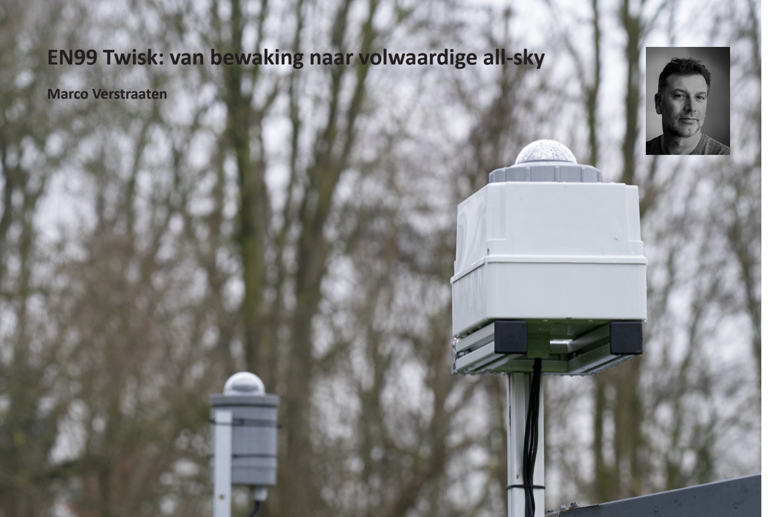
Figuur 1. De nieuwe setting in Twisk. Op de achtergrond de ASI-ZWO 183, op de voorgrond de Nikon met Sigma 8 mm fish-eye lens.
