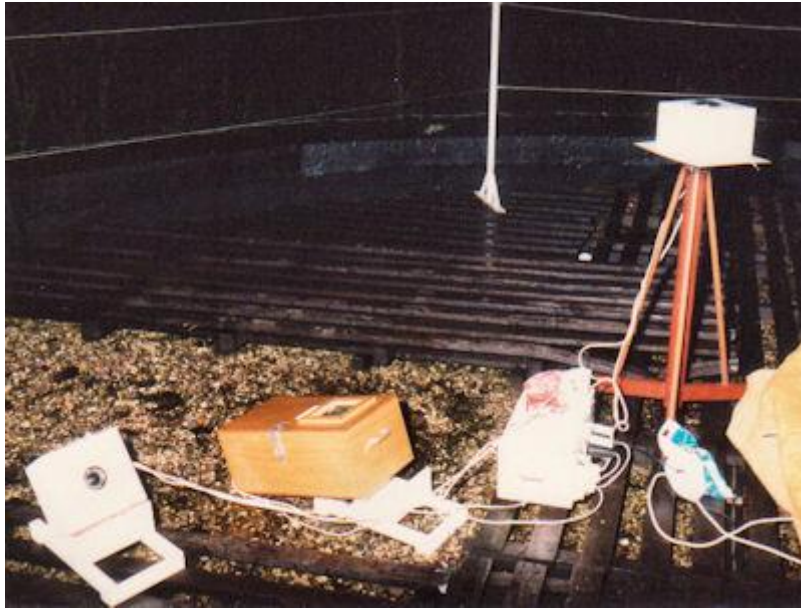
Figuur 2. De all sky camera in een kistje op een oud statief van de Werkgroep voor Sterrenkunde uit Denekamp. Het houten kistje dat schuin opgesteld staat is nu de tijdelijke behuizing van de huidige all sky camera. Het kistje is dus al 31 jaar oud....
