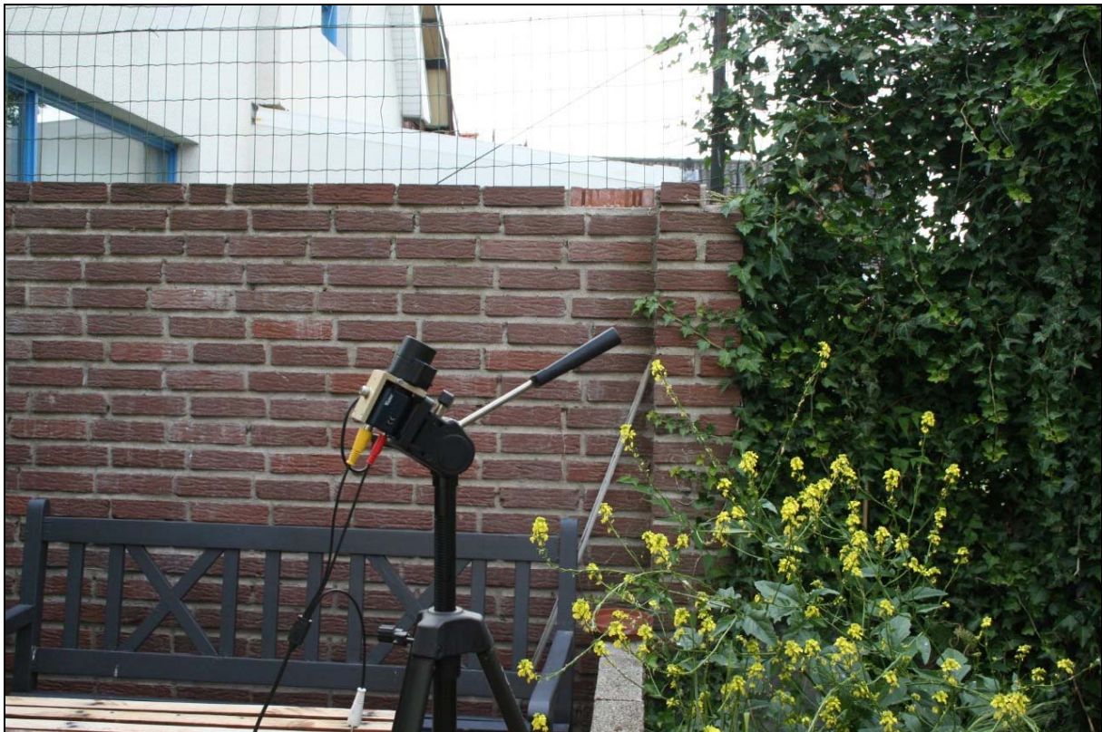
Foto 1: Basisopstelling (MBB1) Watec 902H voorzien van Tamron 3-8mm f1.0.
