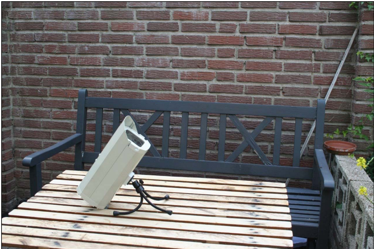
Foto 2: Opstelling MBB2, de camera ingebouwd in een behuizing.
