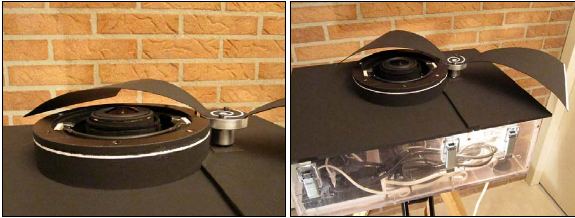
Foto's 2 en 3: All-Sky opstelling voorzien van sector
