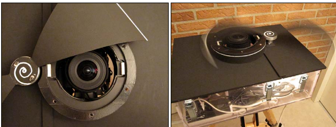
Foto's 4 en 5: All-Sky opstelling voorzien van sector, de koepelverwarming is zichtbaar
