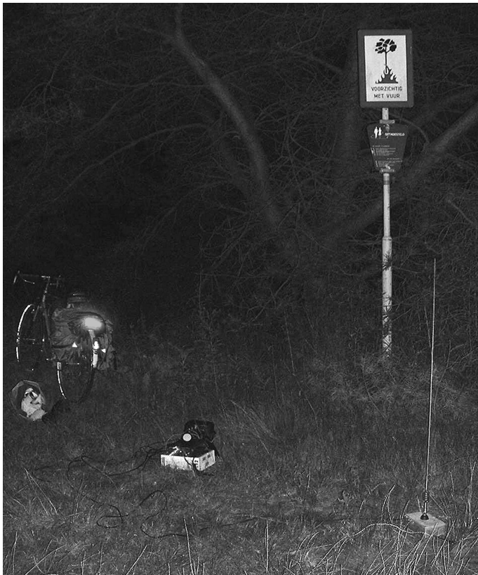
Figuur 1 (links) : De radio apparatuur is opgesteld. Op de voorgrond de antenne.
