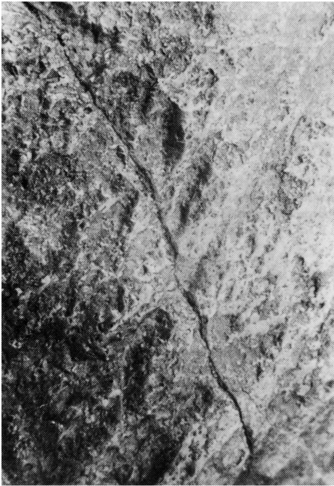
Figure 3: Het oppervlak vertoont vele putjes en geultjes. Sporen van verwerking zijn te zien, met name in de scheur. De foto toont een stuk van ongeveer 2x2 cm.
